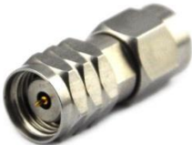
型号：SCOA-292M185M-JJS 描述：2.92mm(公)-1.85mm(公) 精密转接器，不锈钢材质，DC-40GHz，50Ω
