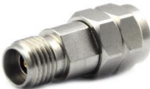
型号：SCOA-292F24M-KJS 描述：2.92mm(母)-2.4mm(公)精密转接器，不锈钢材质，DC-40GHz，50Ω
