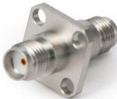
型号：SCOA-SMAFSMAF-KFKG 描述：SMA(母)-SMA(母)精密转接器，四孔法兰，不锈钢材质，DC-26.5GHz，50Ω
