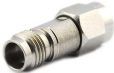
型号：SCOA-292M24F-JKS 描述：2.92mm(公)-2.4mm(母)精密转接器，不锈钢材质，DC-40GHz，50Ω
