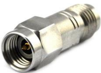
型号：SCOA-292M185F-JKS 描述：2.92mm(公)-1.85mm(母) 精密转接器，不锈钢材质，DC-40GHz，50Ω
