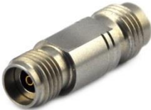
型号：SCOA-292F185F-KKS 描述：2.92mm(母)-1.85mm(母) 精密转接器，不锈钢材质，DC-40GHz，50Ω
