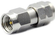
型号：SCOA-292M24M-JJS 描述：2.92mm(公)-2.4mm(公)精密转接器，不锈钢材质，DC-40GHz，50Ω
