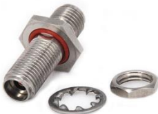
型号：SCOA-292F292F-KYKG 描述：2.92mm(母)-2.92mm(母)精密转接器，穿墙法兰，不锈钢材质，DC-40GHz，50Ω
