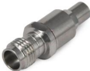
型号：SCOA-24FGPPOM-KJ 描述：2.4mm(母)-GPPO(Mini-SMP)(公)精密转接器，不锈钢材质，DC-40GHz，50Ω
