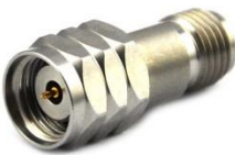
型号：SCOA-292F185M-KJS 描述：2.92mm(母)-1.85mm(公) 精密转接器，不锈钢材质，DC-40GHz，50Ω
