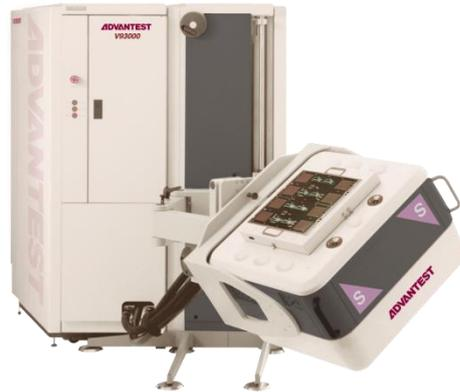
爱德万的可扩展平台 V93000 在一台测试系统中，能够集合最快的数字测试、精确的模拟和射频测量资源。由于大多数功能已经被集成到系统的测试头中，V93000 在提供优秀的速度同时保持最低的固有噪声。由于测试板卡本身集成度高，不同测试资源可分散管理配置，爱德万 V93000 SoC 系列提供绝佳的灵活度。只要有测试需求改变，它的模块化设计可以使你很方便的扩充系统，兼容新的模块和仪器。
