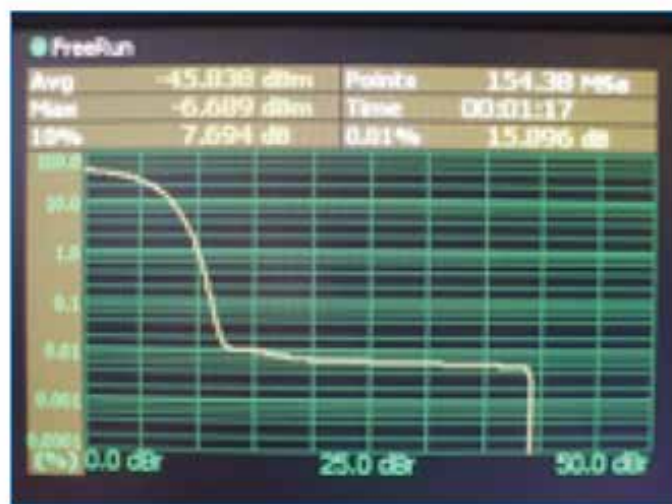
(d) Power measurements of pulse-train in statistical mode
