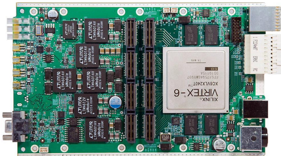
图3 ADQ V6 数字转换器系列高速采集板卡
