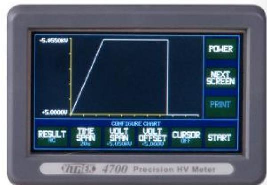
4700型的图表模式自动显示多达300个读数的比例图，有助于验证电压斜升与停留时间、欠冲、过冲和漂移。
