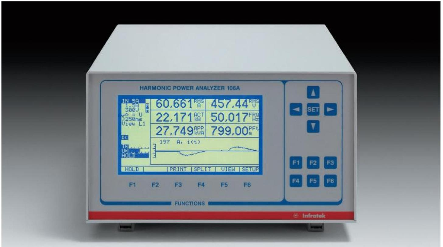
**Infratek 106A** 高精度宽频带功率分析仪电流范围覆盖 1mA-40A，为工程师提供测量低功耗、空载变压器功率因数低时的功率、或驱动大型电机的变频器的功率的方法。
